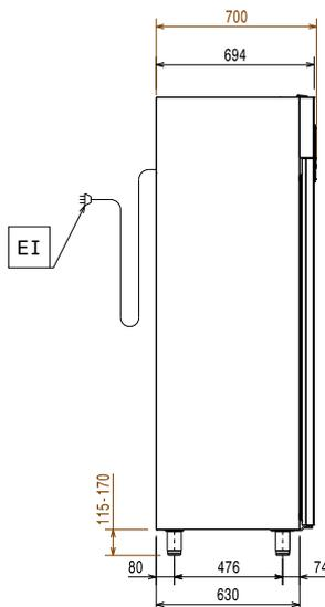
EI = Conexión eléctrica (energía)
